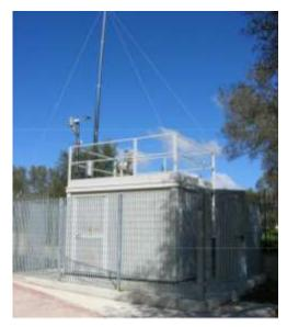
Parametri rilevati: SO2, NOx, NO, NO2, CO, O3, BTeX, PM10, PM2.5, dati meteo
